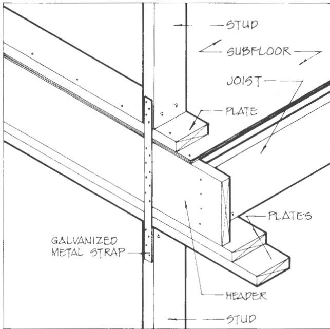
Figure 4.44. Stud-to-Stud Connections
