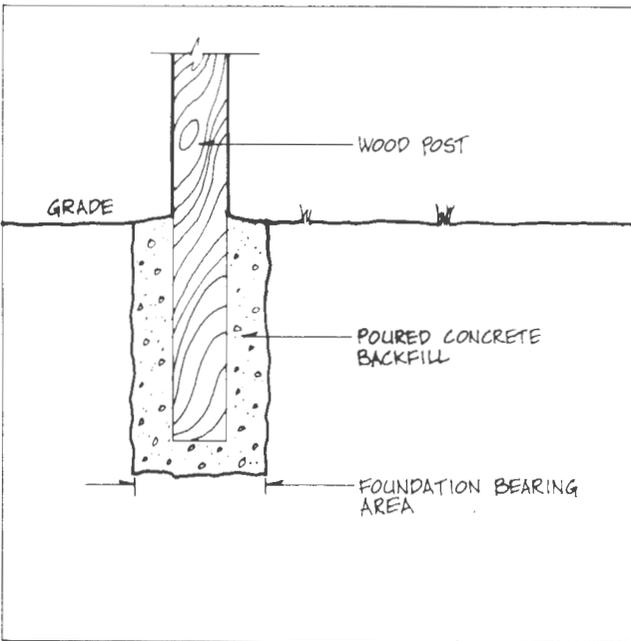
Figure 4.10. Concrete Backfill
